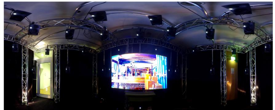
Fig. 4: Panoramaansicht des SV\_XL mit 31 Aktivlautsprechern und 85"-Monitor (equirektangulare Abbildung)
