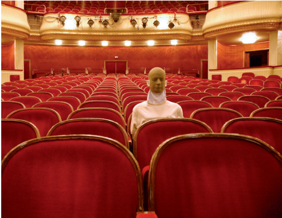
Abbildung 1: Messroboter FABIAN des Fachgebiets Audiokommunikation der Technischen Universität Berlin im Burgtheater Wien bei der Akquisition binauraler Raumimpulsantworten
